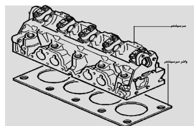
شکل ۳. دو قطعه نمونه با برهمنکنش نوع اول (سرسیلندر و واشر مربوطه)
