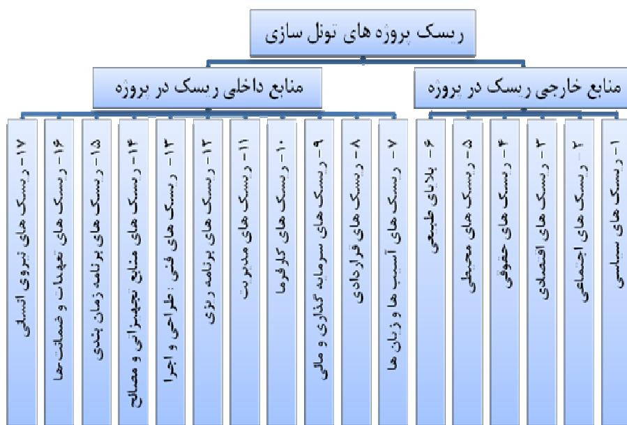
شکل ۱. ساختار شکست ریسک پروژه‌های تونل‌سازی (۱۷ ریسک اصلی)
