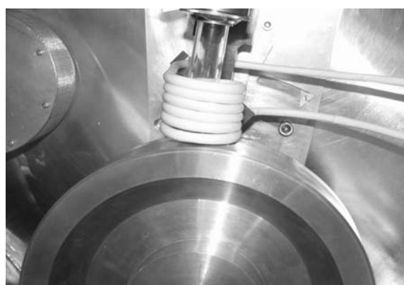
شکل ۲. پیچه القایی و دیسک مسی دستگاه ذوب‌ریسی
