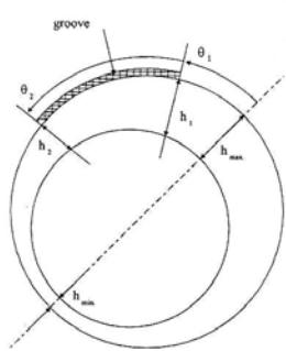
شکل ۲. مشخصات هندسی یاتاقان با شیار محیطی [۷]
