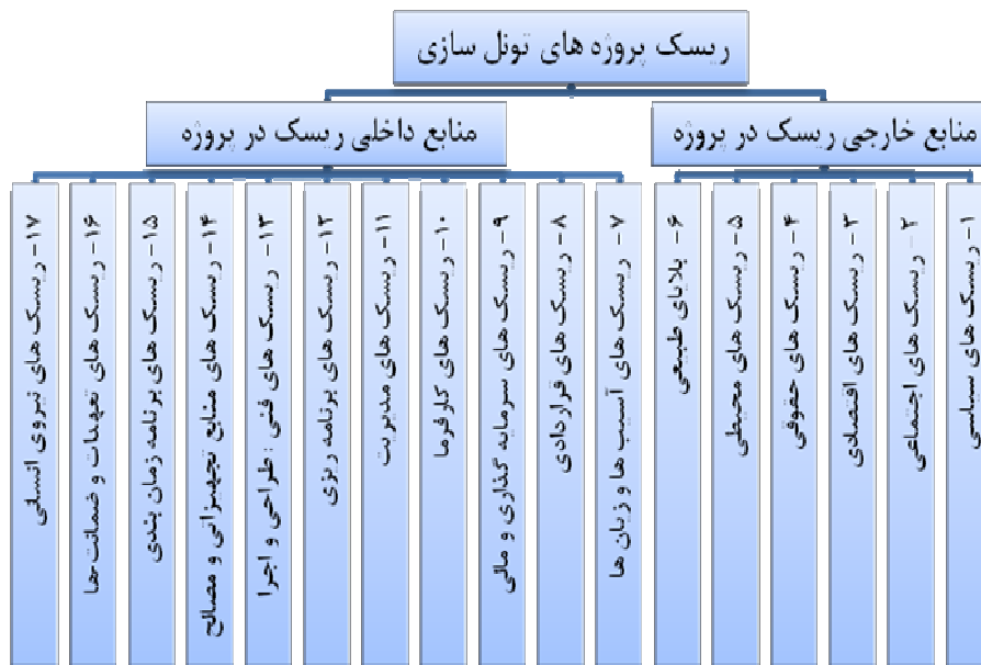
شکل ۱. ساختار شکست ریسک پروژه‌های تونل‌سازی (۱۷ ریسک اصلی)
