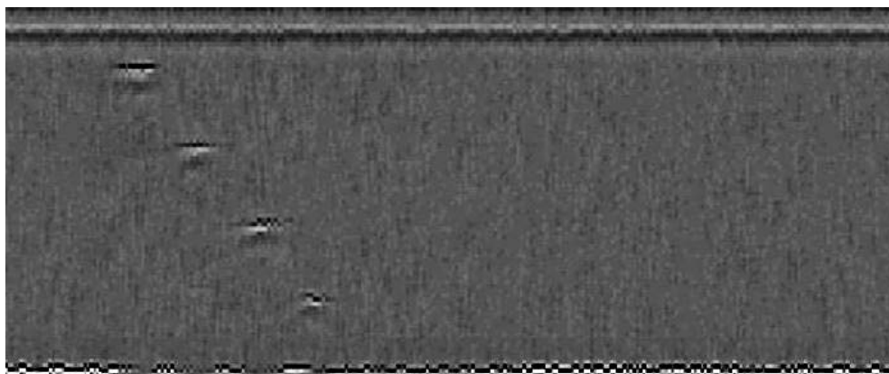
شکل ۱۰. تصویر روبش B حاصل از قطعه سوم با ۴ بازتابنده
