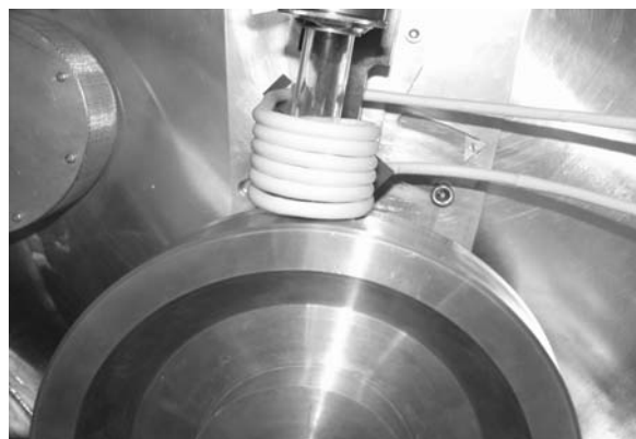
شکل ۲. پیچه القایی و دیسک مسی دستگاه ذوب‌ریسی
