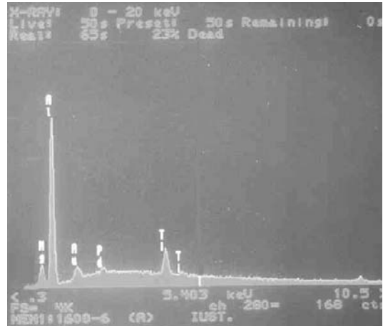
شکل ۸. آنالیز EDS از دانه‌های اسپینل
