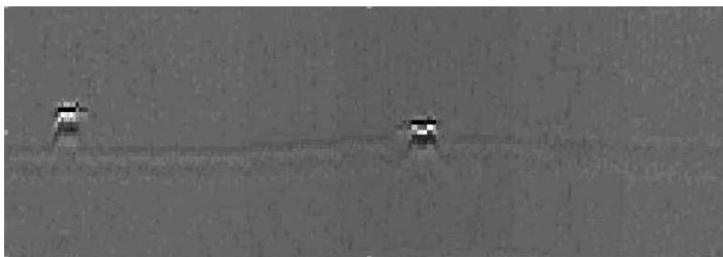
شکل ۸. تصویر روبش B قطعه دوم با دو بازتابنده
