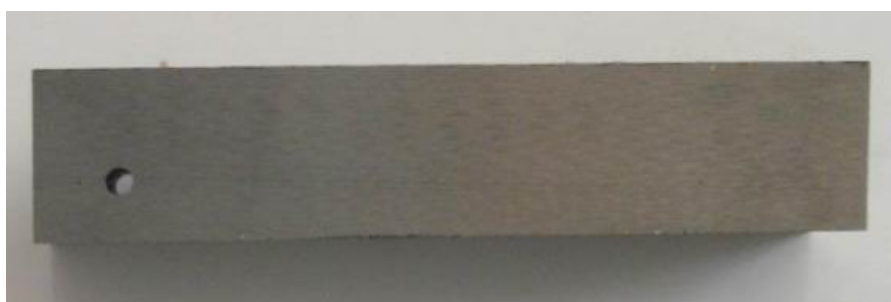
شکل ۵. قطعه اول با ۱ بازتابنده در نیمه پایینی
