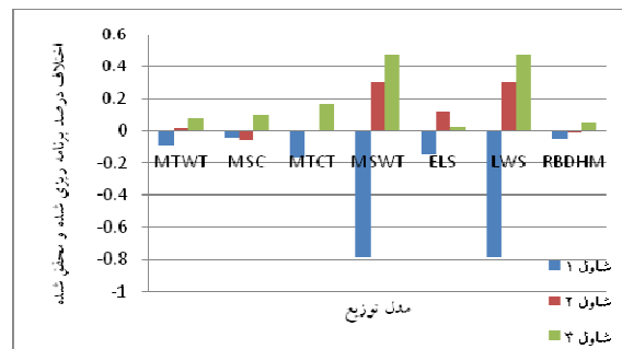
شکل ۱۰. اختلاف درصد برنامه‌ریزی شده و محقق شده تولید شاول‌ها برای کامیون ۱۵۰ تنی
