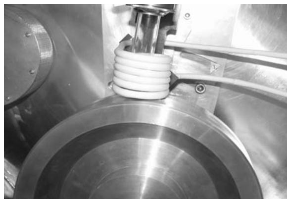
شکل ۲. پیچه القایی و دیسک مسی دستگاه ذوب‌ریسی
