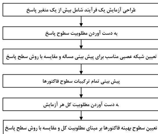
شکل ۳. الگوریتم روش پیشنهادی برای بهینه سازی چند پاسخ با استفاده از شبکه عصبی
